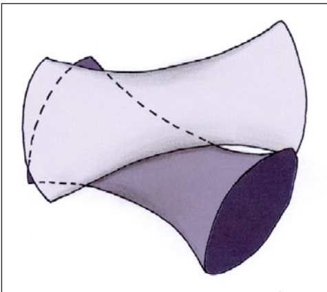
Abb. 3. Hyperboloide Kraftübertragung. Zwei Hyperboloide vermitteln die Drehungen von einer Welle auf eine beliebige anders gerichtete (aus Heine 2007).
